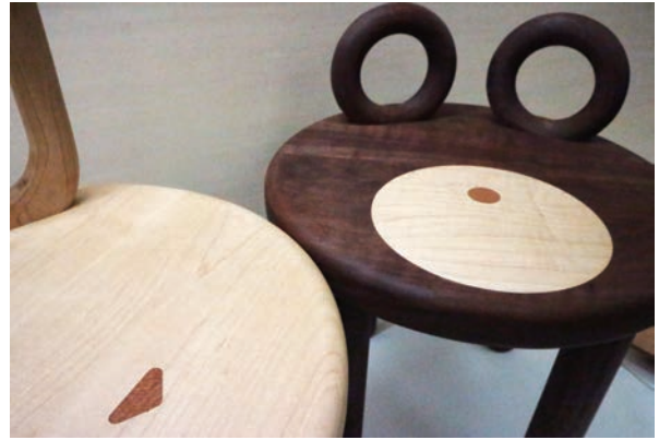
[写真6: 無垢材による彫刻象嵌を施した学生作品]
