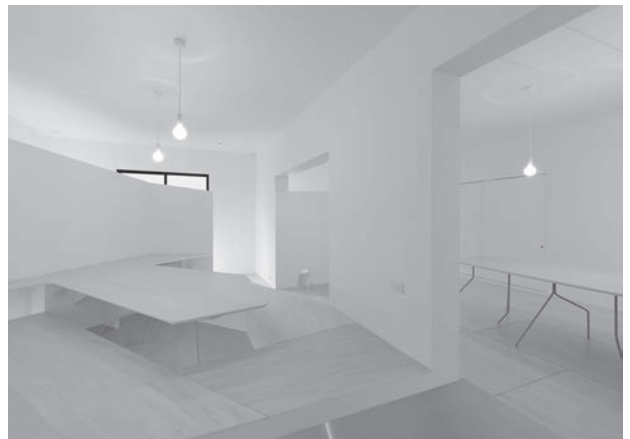
図 13 リビング兼ダイニング（左）とセカンドリビング（右）を見る。リビング兼ダイニングは掘り炬燵になっており、座面下は収納スペースになっている。
